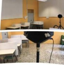
Figura 4 - Posizionamento dei pannelli antiriflessione in aula, 2026 polivalente per la misurazione dell'occupazione dell'aula.
